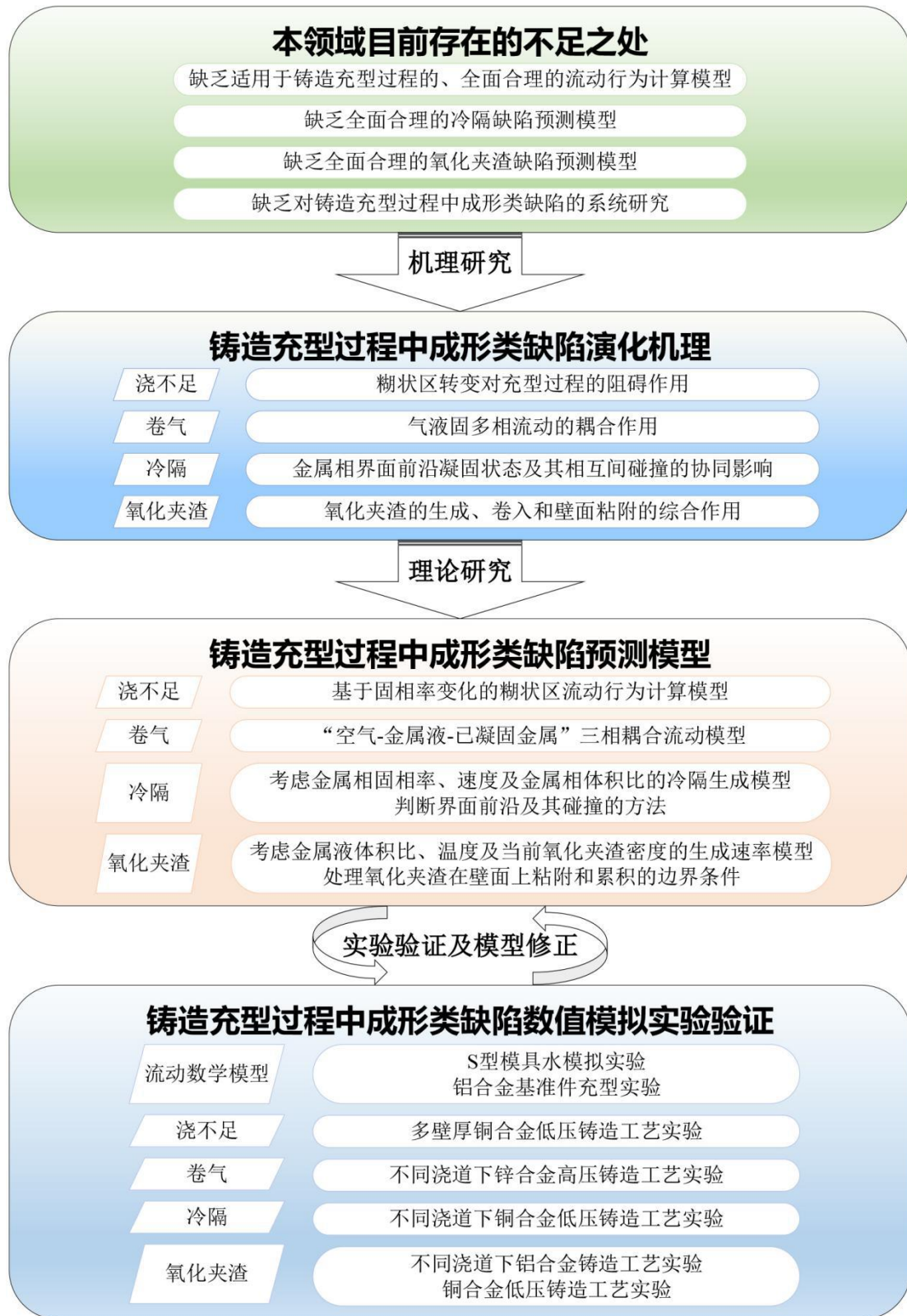
图 1-16 铸造充型过程中成形类缺陷演化机理及数值模拟的研究路线图
