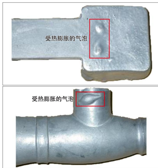
图 5-7 对锌合金压铸件进行加热处理的效果
