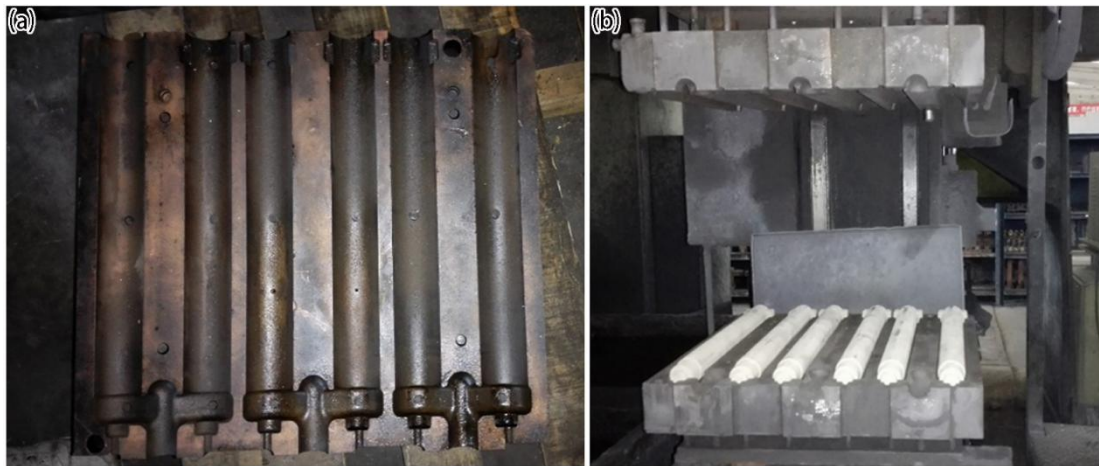
图 5-2 铜合金低压铸造实验：(a) 模具；(b) 砂芯
